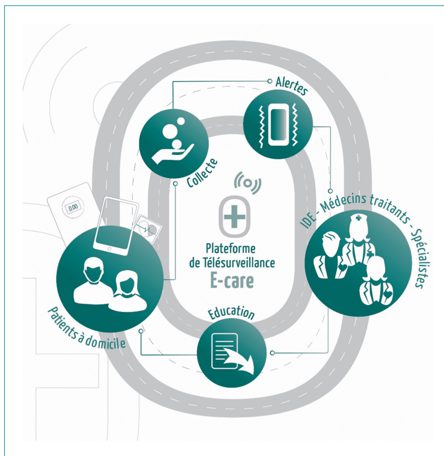
Figure 1. Version 1 de la plateforme générique de télémédecine développée dans le projet E-care de télésurveillance des patients insuffisants cardiaques. Cette plateforme repose sur : des capteurs médicaux non intrusifs (TA, FC, O2, poids), communiquant par Bluetooth, permettant de remonter, en temps réel, des informations physiologiques sur l'état de santé du patient ; une tablette tactile, communiquant par wifi ou par 3G/4G ; et un serveur Internet hébergeant un moteur d'inférence générant des alertes : MyPredi. Ces dernières signent une dégradation des pathologies chroniques du patient. Elles sont accessibles aux professionnels de santé via un portail Internet sécurisé.
