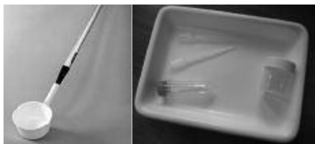
Figure 22. matériels de collecte de larves : louche, plateau plastique blanc, pipettes et flacons pour l'échantillonnage des larves. (© T. Coffinet)
