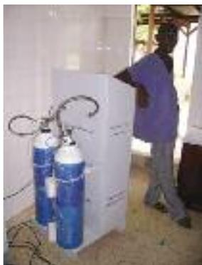
Figure 2. Booster pour remplissage de bouteilles.
